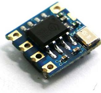
片内自动完成所有的 RF 及 IF 调谐，在开发和生产中省略了手工调节的工艺过程，自然也降低了成本，增强了产品的竞争力。此型号外形小巧，宽度不到 1cm，针对小空间应用，控制模块使能端能获得更佳的平均功耗。且有很强的抗干扰能力。
